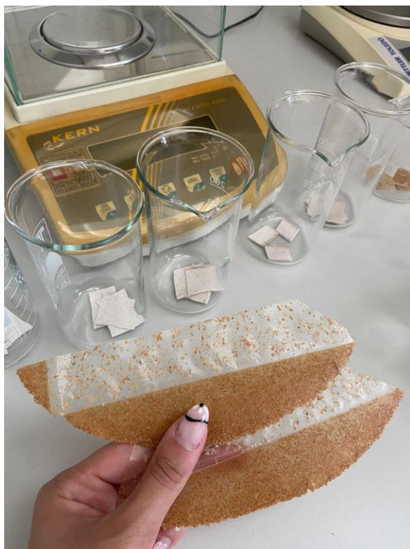
Slika 27. Uzorak prije izrezivanja i pripremljeni uzorci za inicijalno vaganje početne mase.
