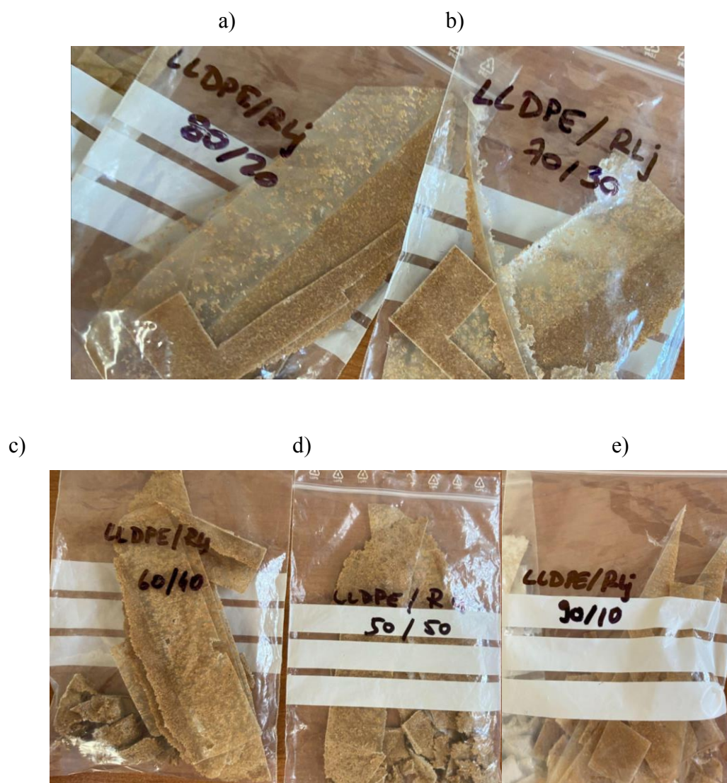
Slika 23. Uzorci LLDPE/RLJ s različitim udjelom RLJ: a) LLDPE/RLJ 80/20, b) LLDPE/RLJ 70/30, c) LLDPE/RLJ 60/40, d) LLDPE/RLJ 50/50, e) LLDPE/RLJ 90/10.
