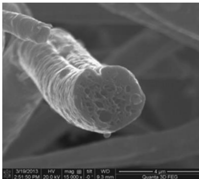
Slika 14. SEM mikrografija lignoceluloznih nanofibrila s PAN jezgrenom vlaknom. [26] Porozno jezgreno vlakno dobiva se od ligninskih i celuloznih nanofibrila. [25]
