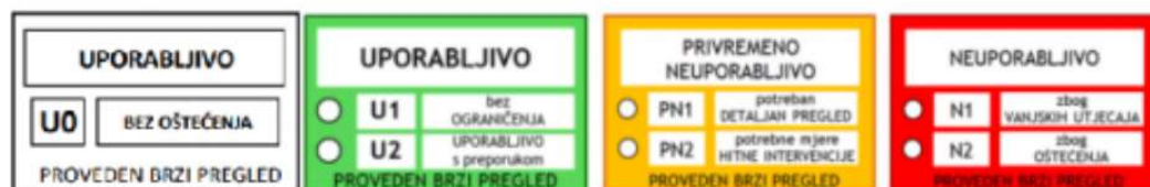
Slika 24. Prikaz naljepnica o uporabljivosti zgrada [37]
