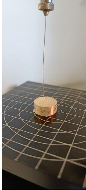
Slika 41. Prikaz snimanja kontaktnog kuta
