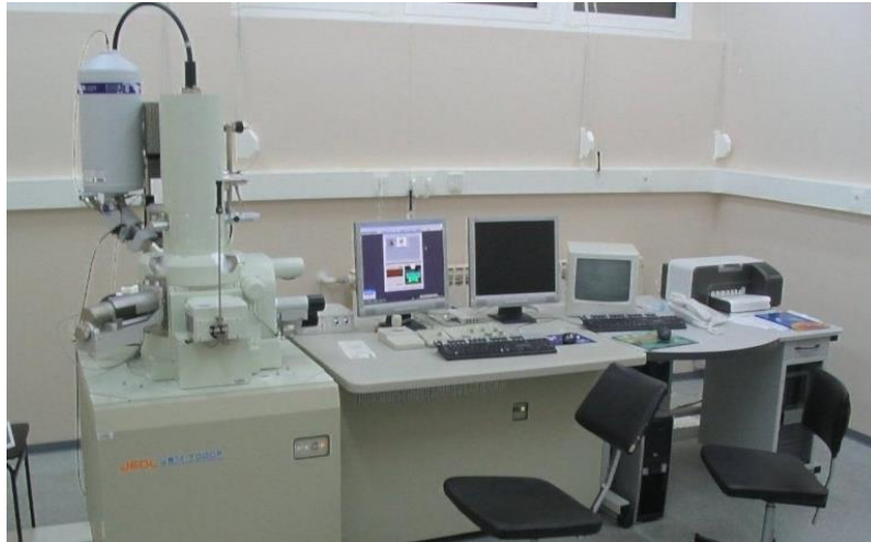
Slika 22. Visokorezolucijski pretražni elektronski mikroskop JEOL JSM-7000F [39]
