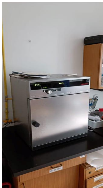
Slika 13. Oksidacija, adsorpcija, sušenje uzoraka u peći
