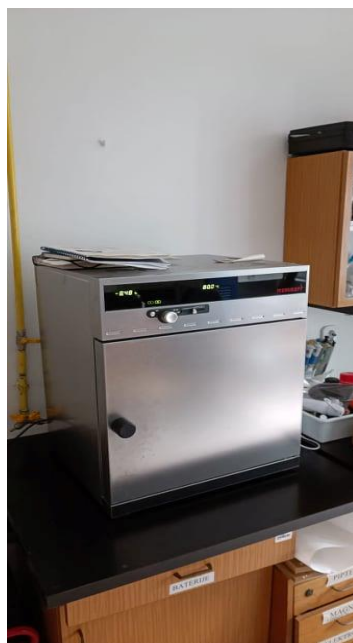
Slika 13. Oksidacija, adsorpcija, sušenje uzoraka u peći
