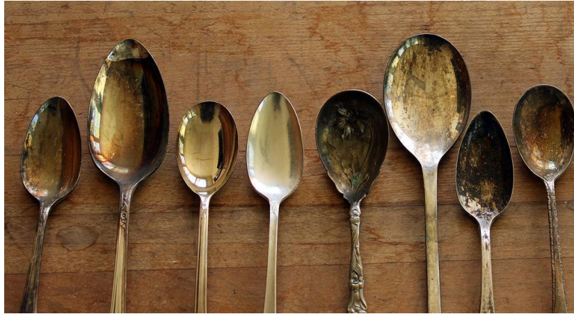
Slika 3. Primjer kemijske korozije na srebru zbog sumporovodika iz zraka [10]
