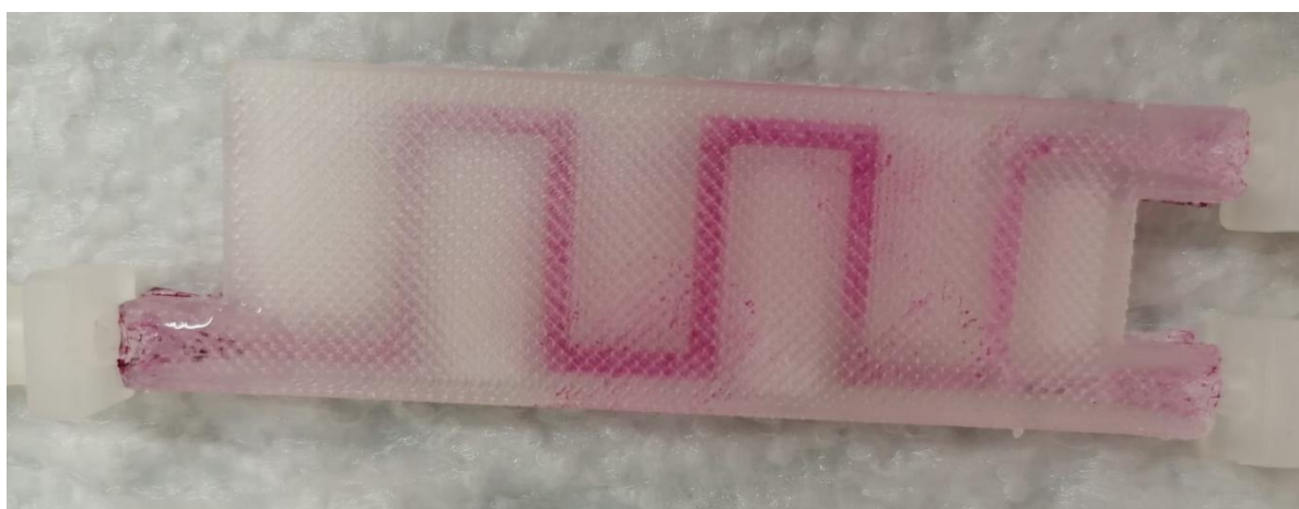
Slika 44. Milireaktor sa senzorskim filmom kroz kojeg je protjecala otopina pH-vrijednosti 2,1
