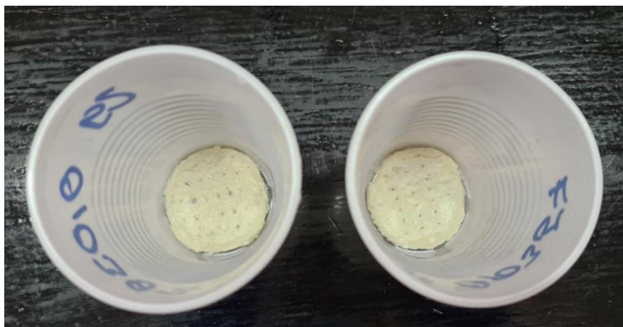
Slika 5. Staklene mrežice s imobiliziranim TiO 2
