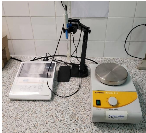
Slika 3.5. pH elektroda BlueLine 16 SI Analytics i magnetska mješalica Rotamix S-10 Domel d.o.o.
