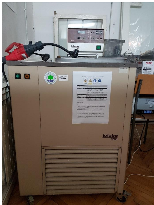
Slika 8 : Kriostat Julabo FP80 ( izvor: vlastita fotografija)
