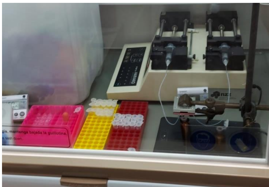
Slika 16. Reakcijski sustav s mikroreaktorom
