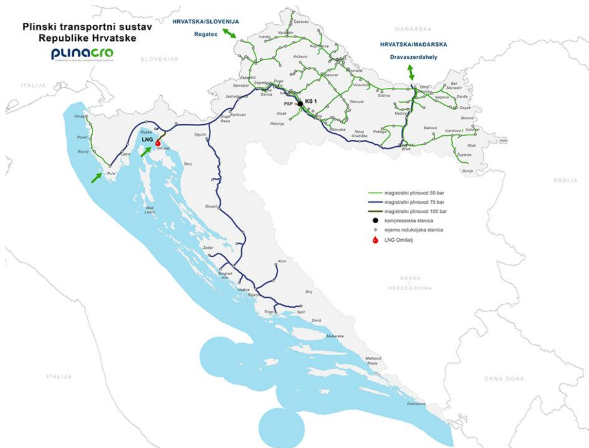
Slika 7. plinski transportni sustav RH
