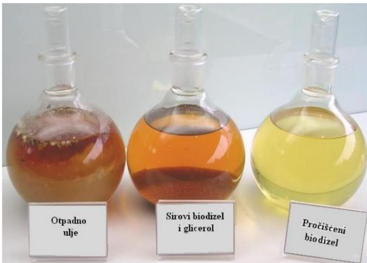
Slika 2. Prikaz međuprodukta i produkta iz otpadnog ulja
