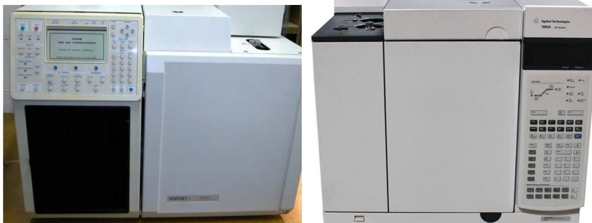
Slika 13. Plinski kromatografi: Varian 3800 i Agilent 7890A
