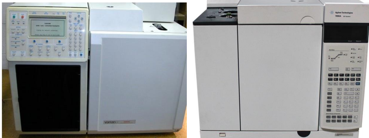
Slika 13. Plinski kromatografi: Varian 3800 i Agilent 7890A
