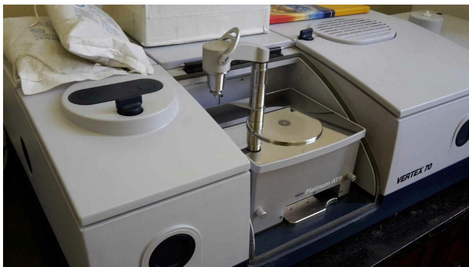
Slika 11. FTIR spektrometar - Bruker Vertex 70
