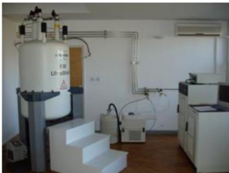
Slika 12. NMR Spektrometar Bruker Avance 300
