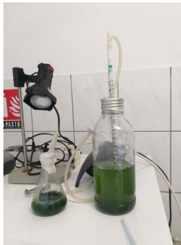
Slika 9. Uzgojena mikroalga Scenedesmus sp. uz aeracijsku pumpu i lampu.
