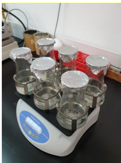
Slika 10. Pokus određivanja toksičnosti PET-a primjenom alge Scenedesmus sp.
