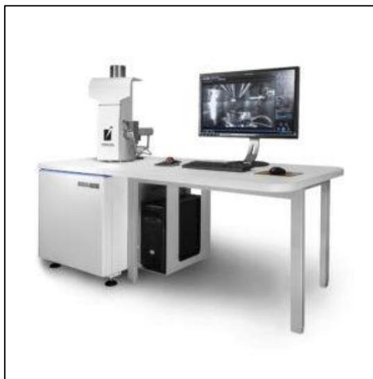
**Slika 3.3.** Skenirajući elektronski mikroskop Tescan VEGA 3 SEM
