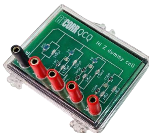
Slika 8. Prikaz slijepa ćelije korištene u istraživanju.
