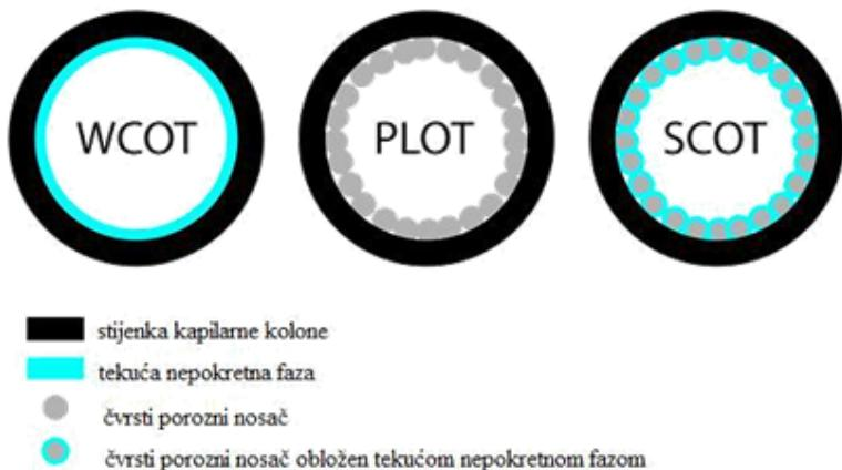
**Slika 7.** Vrste kapilarnih kolona
