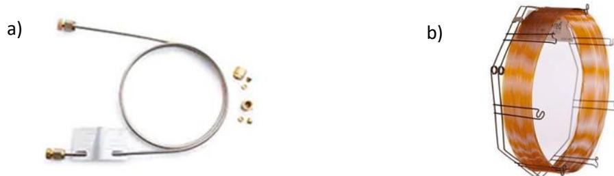
**Slika 6.** Prikaz GC kolona: a) punjena kolona; b) kapilarna kolona
