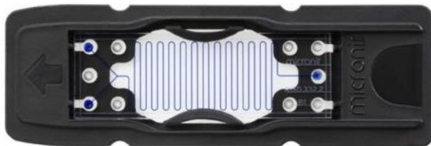
Slika 7. Mikroekstraktor s dva ulaza “Y” oblika i jednim izlazom
