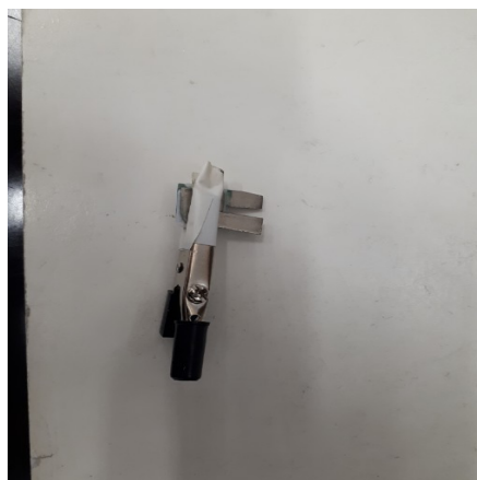
Slika 3.9. rGO papir/rGO papir hibridni superkondenzator
