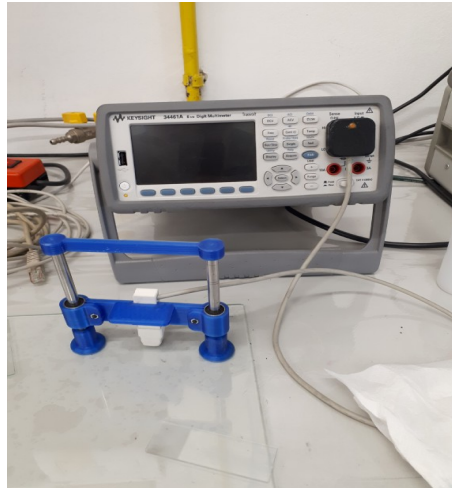
Slika 3.8. Uređaj za mjerenje otpora rGO papira
