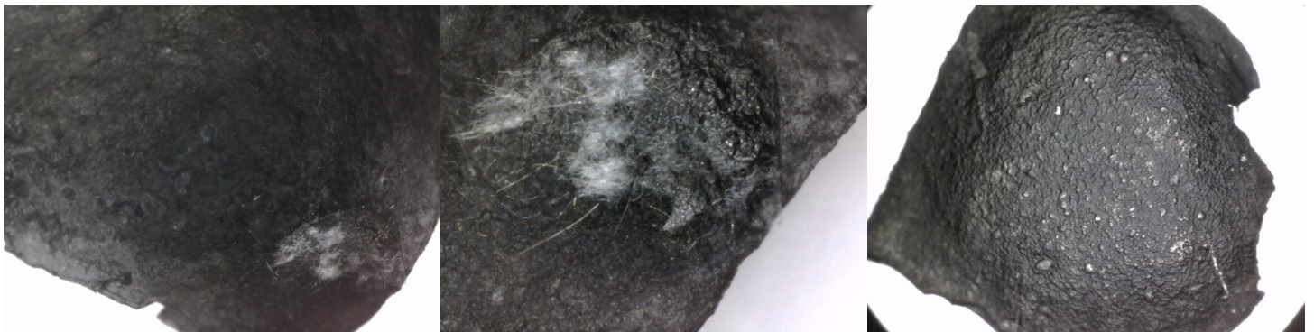
Slika 4.19. Površina rGO papira s istaloženim cinkom
