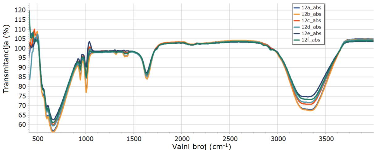
*Slika 33. FTIR spektar uzorka 12 nakon pripadajućeg mikrovalnog zračenja (12A-  $100\text{ W}$ , 12B-  $180\text{ W}$ , 12C-  $300\text{ W}$ , 12D-  $450\text{ W}$ , 12E-  $600\text{ W}$  i 12F-  $800\text{ W}$ )*
