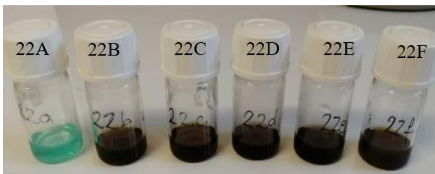
Slika 52. Uzorak 22 nakon raspodjele u 6 bočica i pripadajućeg mikrovalnog zračenja (22A- 100 W, 22B- 180 W, 22C- 300 W, 22D- 450 W, 22E- 600 W i 22F- 800 W)
