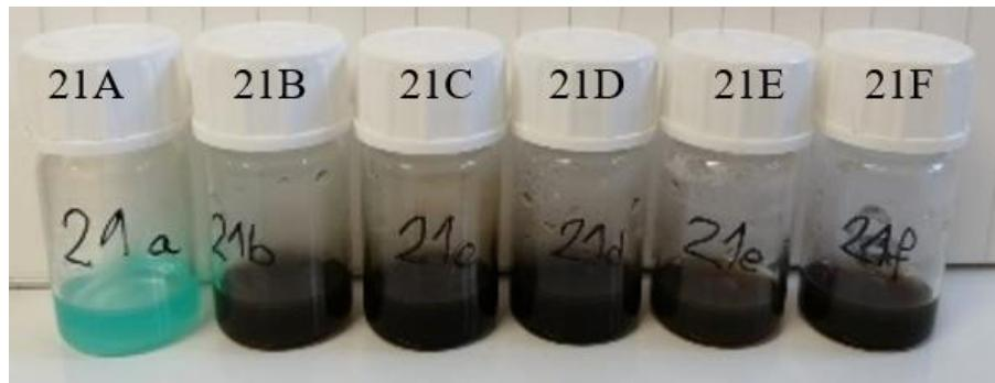
*Slika 50. Uzorak 21 nakon raspodijele u 6 boćica i pripadajućeg mikrovalnog zračenja (21A- 100 W, 21B- 180 W, 21C- 300 W, 21D- 450 W, 21E- 600 W i 21F- 800 W)*
