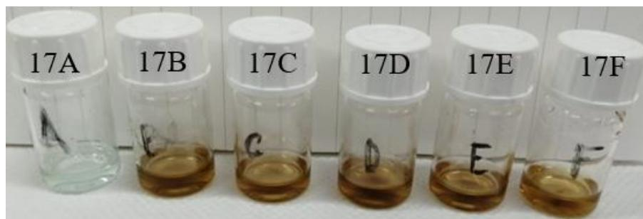
*Slika 42. Uzorak 17 nakon raspodijele u 6 boćica i pripadajućeg mikrovalnog zračenja (17A- 100 W, 17B- 180 W, 17C- 300 W, 17D- 450 W, 17E- 600 W i 17F- 800 W)*
