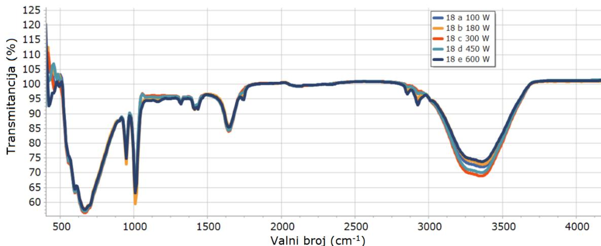
*Slika 45. FTIR spektar uzorka 18 nakon pripadajućeg mikrovalnog zračenja (18A- 100 W, 18B- 180 W, 18C- 300 W, 18D- 450 W, 18E- 600 W i 18F- 800 W)*
