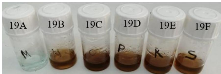
*Slika 46. Uzorak 19 nakon raspodijele u 6 boćica i pripadajućeg mikrovalnog zračenja (19A- 100 W, 19B- 180 W, 19C- 300 W, 19D- 450 W, 19E- 600 W i 19F- 800 W)*
