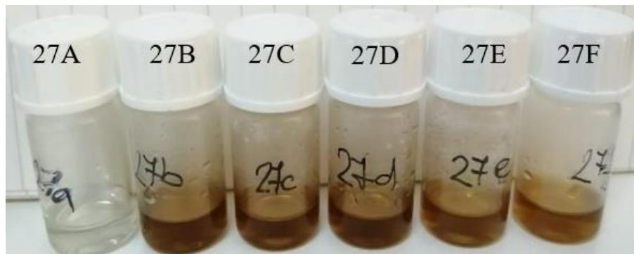
*Slika 62. Uzorak 27 nakon raspodijele u 6 bočica i pripadajućeg mikrovalnog zračenja (27A- 100 W, 27B- 180 W, 27C- 300 W, 27D- 450 W, 27E- 600 W i 27F- 800 W)*
