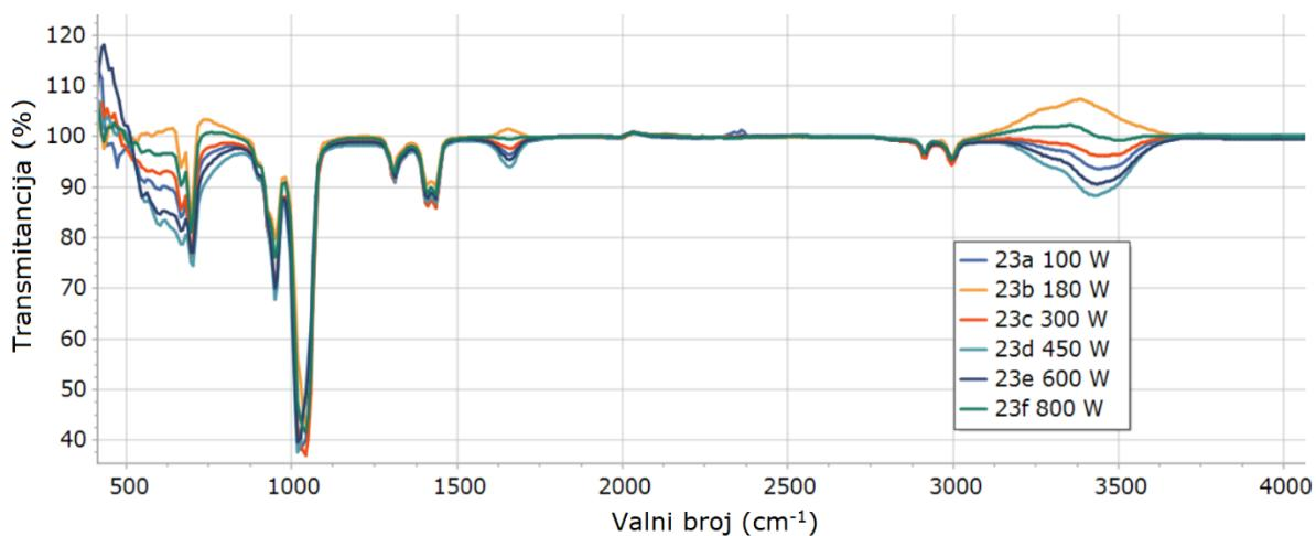
*Slika 55. FTIR spektar uzorka 23 nakon pripadajućeg mikrovalnog zračenja (23A- 100 W, 23B- 180 W, 23C- 300 W, 23D- 450 W, 23E- 600 W i 23F- 800 W)*
