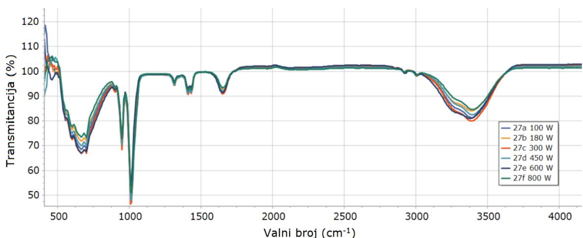
*Slika 63. FTIR spektar uzorka 27 nakon raspodijeljene u različite snage mikrovalnog zračenja (27A- 100 W, 27B- 180 W, 27C- 300 W, 27D- 450 W, 27E- 600 W i 27F- 800 W)*
