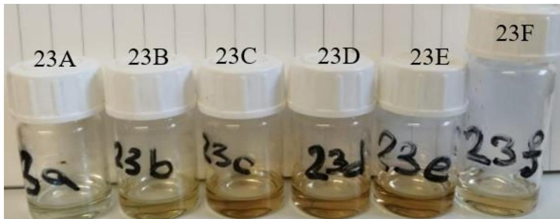
*Slika 54. Uzorak 23 nakon raspodijele u 6 boćica i pripadajućeg mikrovalnog zračenja (23A- 100 W, 23B- 180 W, 23C- 300 W, 23D- 450 W, 23E- 600 W i 23F- 800 W)*
