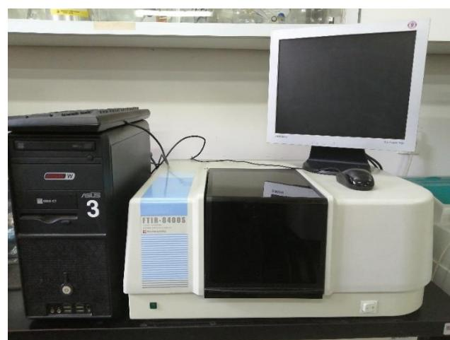
Slika 18. FTIR-8400S Shimadzu
