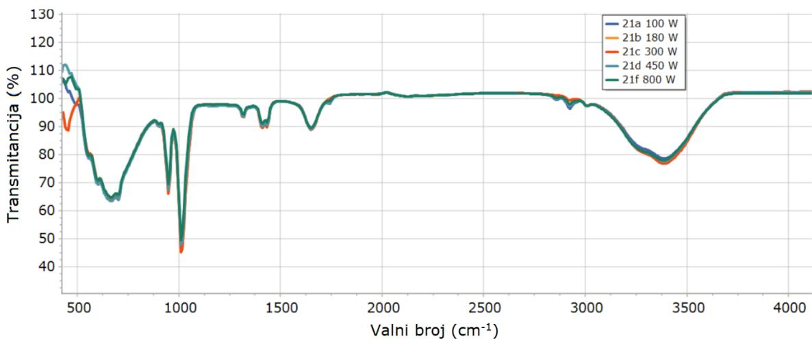
*Slika 51. FTIR spektar uzorka 21 nakon pripadajućeg mikrovalnog zračenja(21A- 100 W, 21B- 180 W, 21C- 300 W, 21D- 450 W, 21E- 600 W i 21F- 800 W)*
