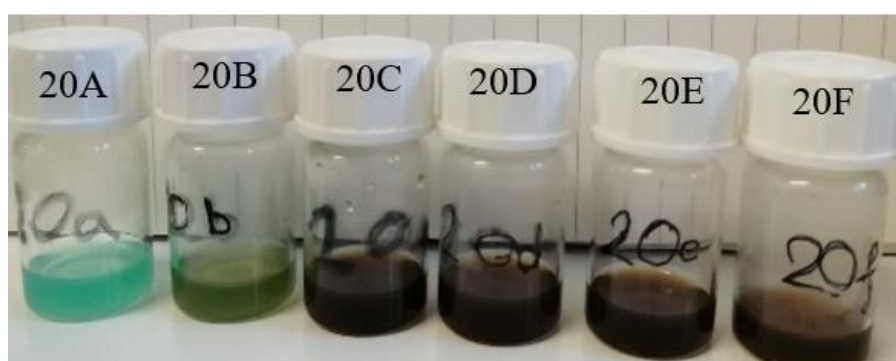
Slika 48. Uzorak 20 nakon raspodjele u 6 bočica i pripadajućeg mikrovalnog zračenja (20A- 100 W, 20B- 180 W, 20C- 300 W, 20D- 450 W, 20E- 600 W i 20F- 800 W)
