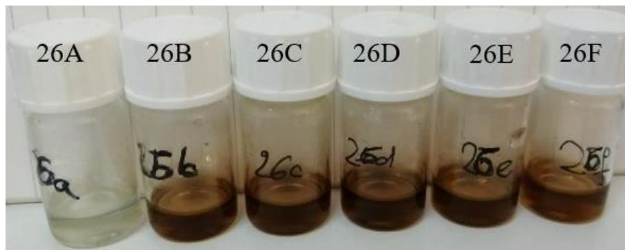
Slika 60. Uzorak 26 nakon raspodijele u 6 bočica i pripadajućeg mikrovalnog zračenja (26A- 100 W, 26B- 180 W, 26C- 300 W, 26D- 450 W, 26E- 600 W i 26F- 800 W)
