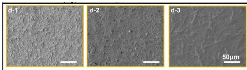
**Slika 12.** SEM slike tipičnih TiO<sub>2</sub>-PTFE nanokompozitnih prevlaka na netretiranim 316L SS, polirane površine s premazom i PDA [17]
