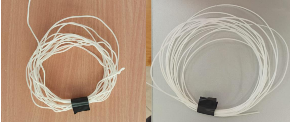
Slika 20. Nepravilni, valoviti filament FP i pravilan, jednolik filament FP
