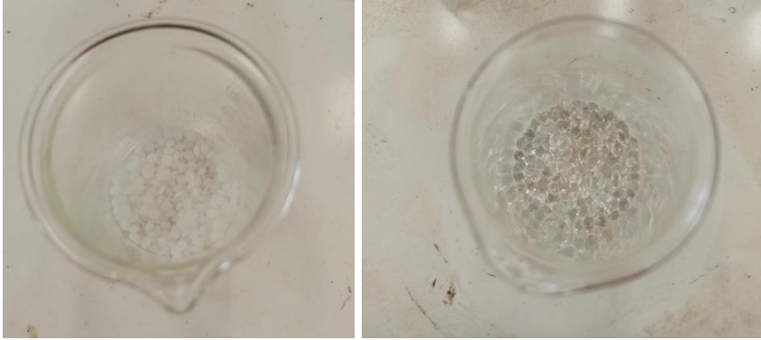
Slika 12. Polikaprolakton pri sobnoj temperaturi i blizu točke taljenja
