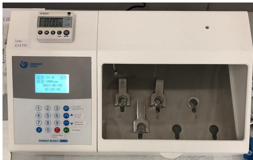
Slika 7. Fotografija ispitivača RYJ-68, Xiangtan Xiangyi Instrument Limited.
