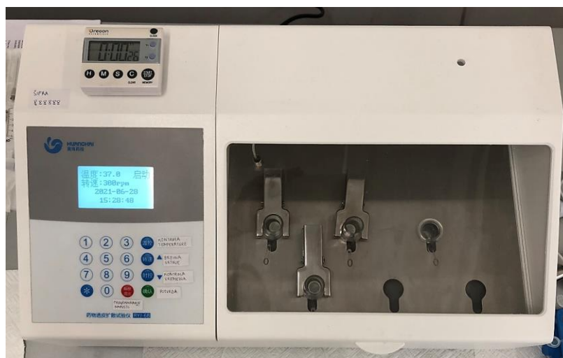
Slika 7. Fotografija ispitivača RYJ-68, Xiangtan Xiangyi Instrument Limited.
