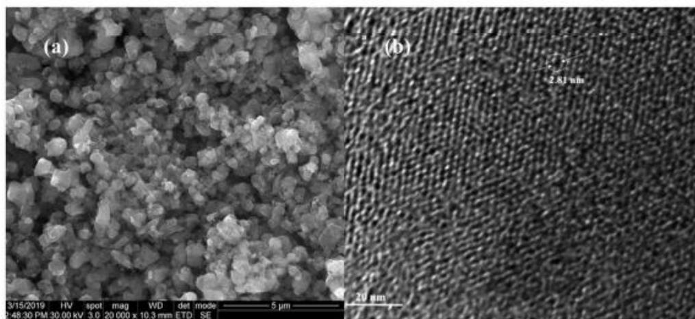
**Slika 12.** Slika MCM-41 snimljena transmisijskom elektronskom mikroskopijom<sup>[24]</sup>
