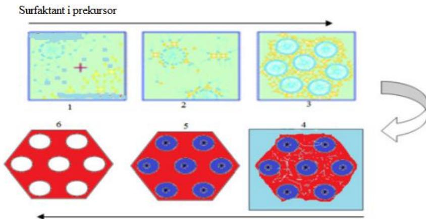
**Slika 14.** Metoda mekog predloška (endopredložak)<sup>[1]</sup>
