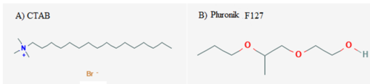
Slika 10. Strukturne formule surfaktanta A) CTAB [29] i B) Pluronik F127 [30]
