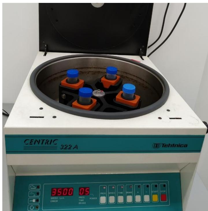
Slika 15. Centrifugiranje pomoću *Centric 322A* centrifuge
