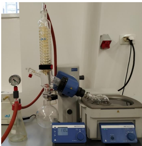
Slika 10. Zagrijavanje i miješanje otopala na uređaju IKA RV 10 Basic rotary evaporator .
