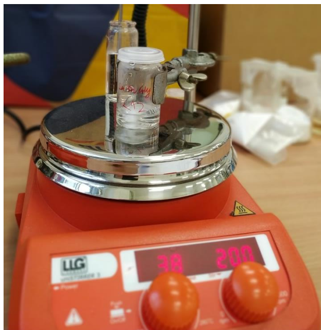
Slika 9. Priprema otopala na magnetskoj miješalici.
