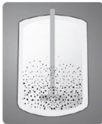
Slika 3. Stanje potpune suspenzije
