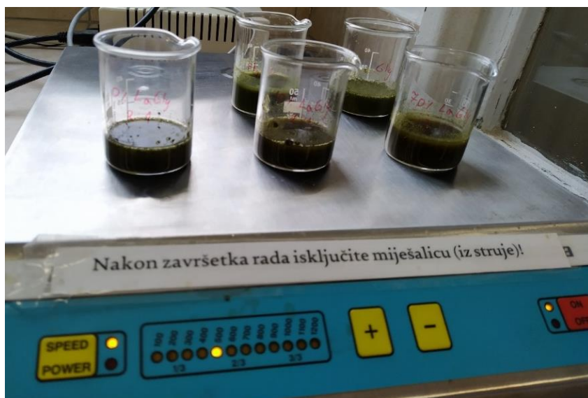
Slika 14. Ekstrakcija polifenola iz trputca na magnetskoj mješalici Rotamix 609 mm, Tehnica
