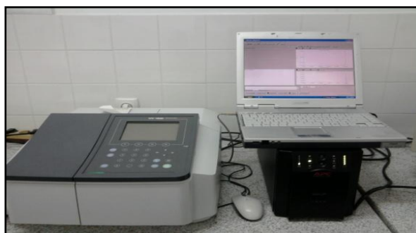
Slika 3.3 Spektrofotometar Shimadzu UV-1800
