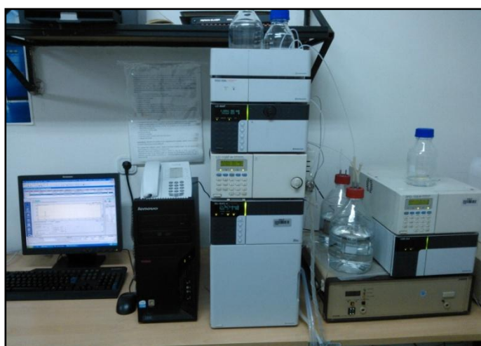
Slika 3.4 HPLC Shimadzu modularni sustav
