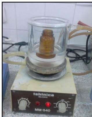
Slika 3.1 Kotlasti reaktor u termostatiranoj kupelji na magnetskoj mješalici
