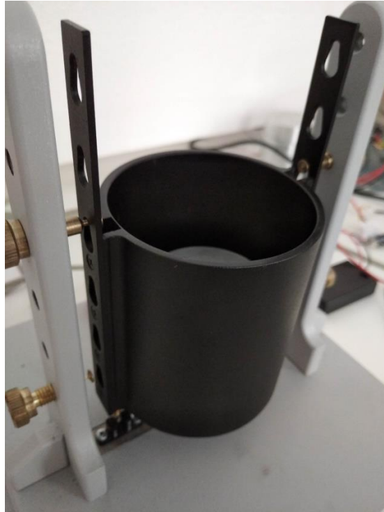
Slika 8. Prikaz osi titranja u izvedenoj aparaturi. Trenutno je nosač uzorka (s aluminijskom slitinom koja nije bila korištena kao uzorak u ovome nizu mjerenja) ovješeno oko treće osi, brojeći od vrha.
