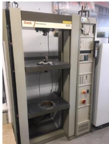
**Slika 24.** Mehanička kidalica Zwick 1455.
