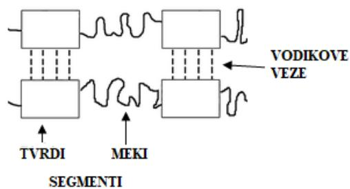
Slika 2. Shematski prikaz TPU blok -kopolimera.
