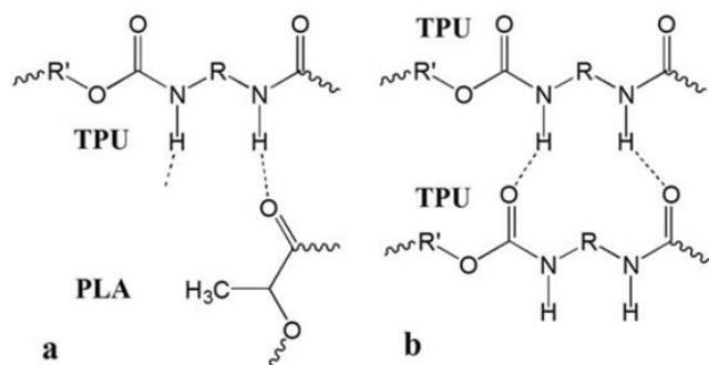
**Slika 31.** Moguća vodikova veza u PLA/TPU mješavinama između a) PLA i TPU i b) između lanaca TPU-a.
