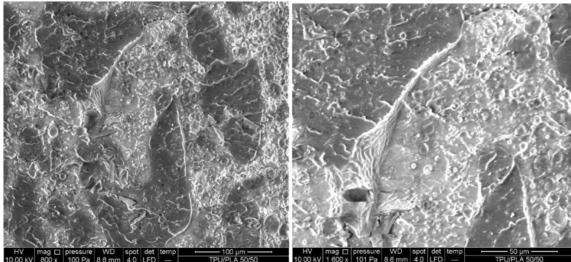
**Slika 42.** SEM mikrografije za mješavinu PLA/TPU 50/50 uz povećanje od 800 i 1600x.
