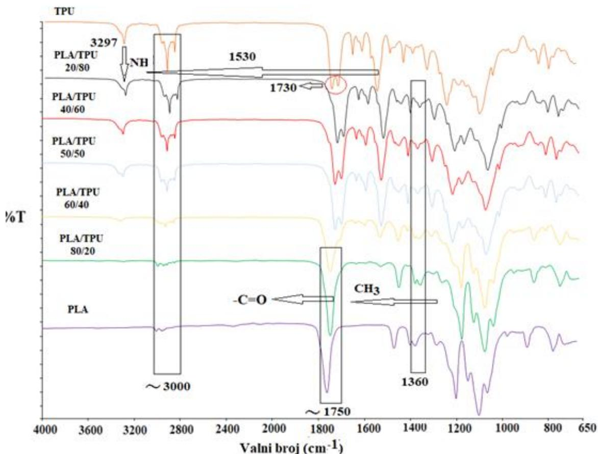
Slika 34. FTIR-ATR spektar TPU, PLA i PLA/TPU mješavina
