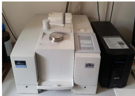
**Slika 23.** FTIR-ATR spektrofotometar Spectrum One, Perkin Elmer.
