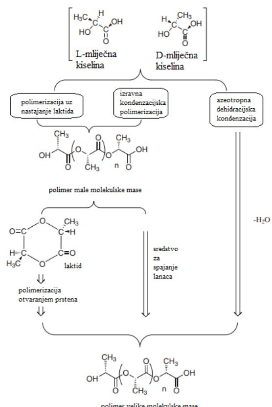
**Slika 9.** Shematski prikaz načina sinteze PLA. [11]
