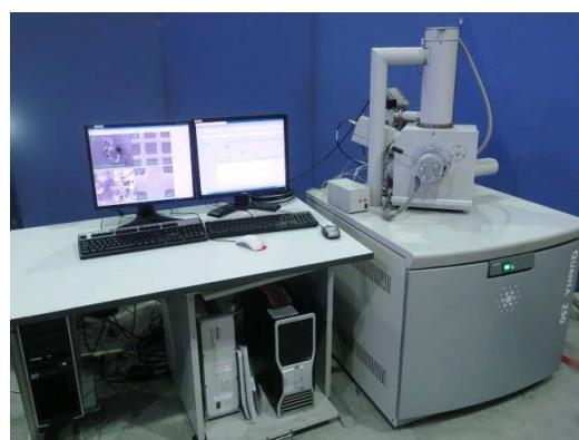
**Slika 25.** Pretražni elektronski mikroskop SEM QUANTA 250, FEI.
