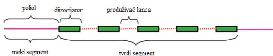
Slika 3. Shematski prikaz građe TPU lanca [4].
