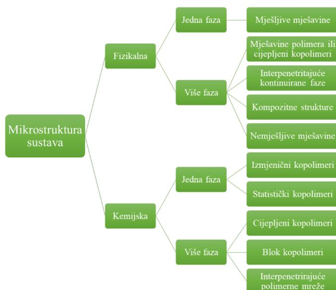
**Slika 11.** Shematski prikaz mikrostrukture sustava.
