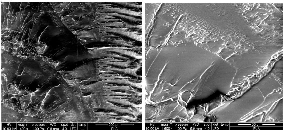
**Slika 38.** SEM mikrografije čistog PLA uz povećanje od 800 i 1600x.
