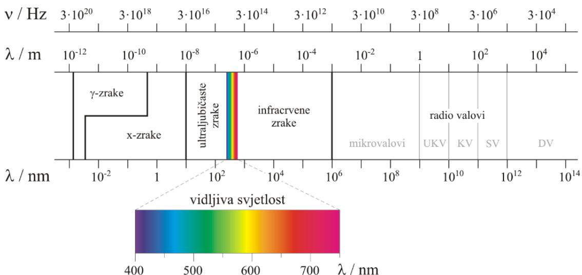
Slika 14. Elektromagnetski spektar.
