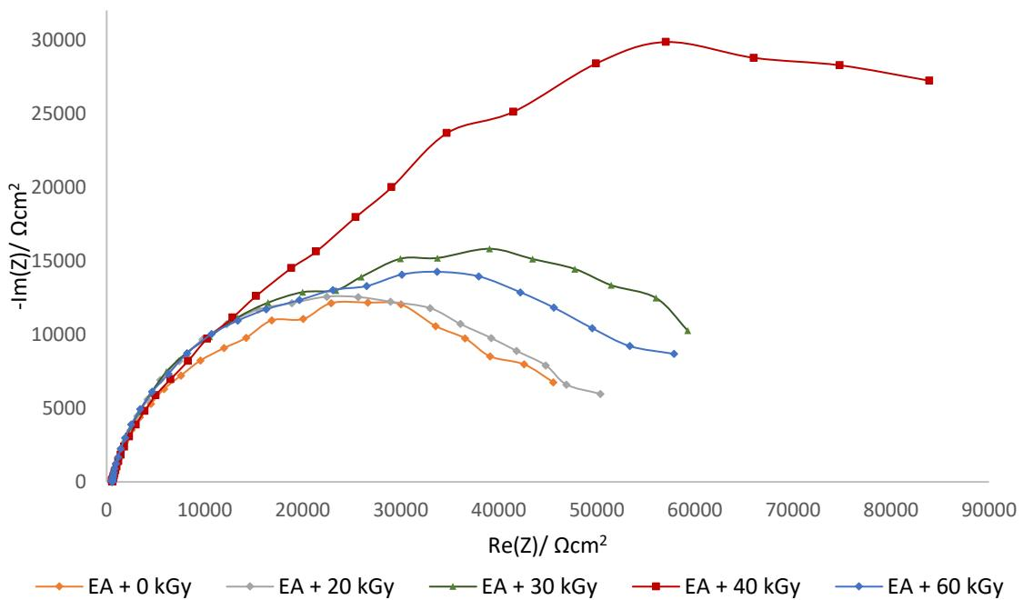
**Slika 17.** Nyquistov dijagram - usporedba rezultata dobivenih EIS-om za neozračene i uzorke ozračene u vodi propuhanoj s N<sub>2</sub>.
