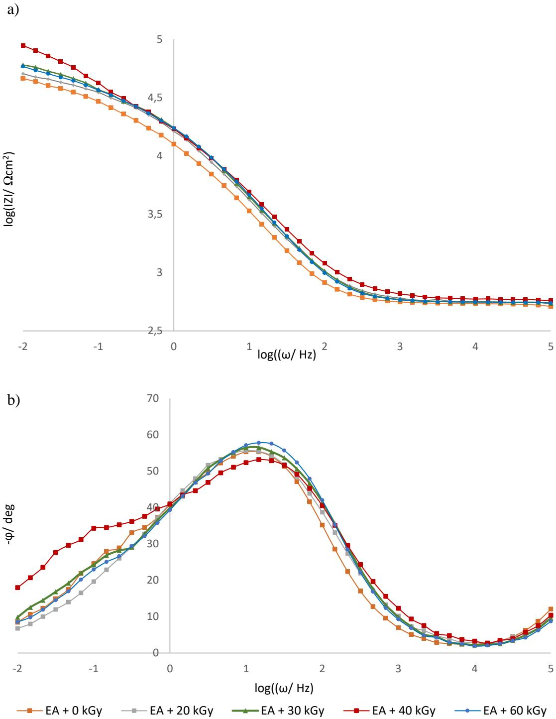
**Slika 18.** Bodeovi dijagrami - usporedba rezultata dobivenih EIS-om za neozračene i uzorke ozračene u vodi propuhanoj s  $\text{N}_2$ .
