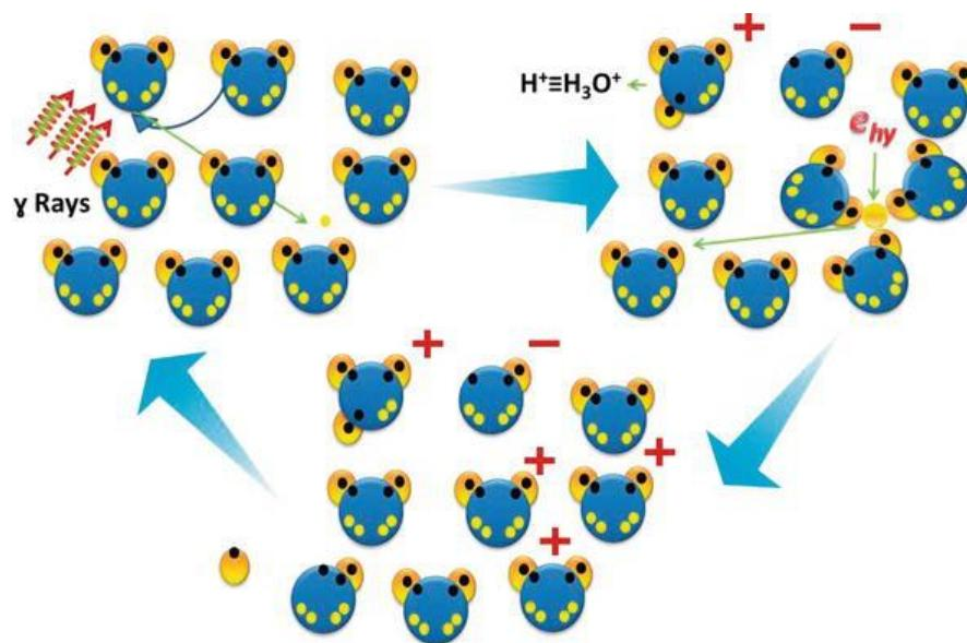
**Slika 15.** Ilustracija radiolize vode inducirane *gama* zračenjem.
