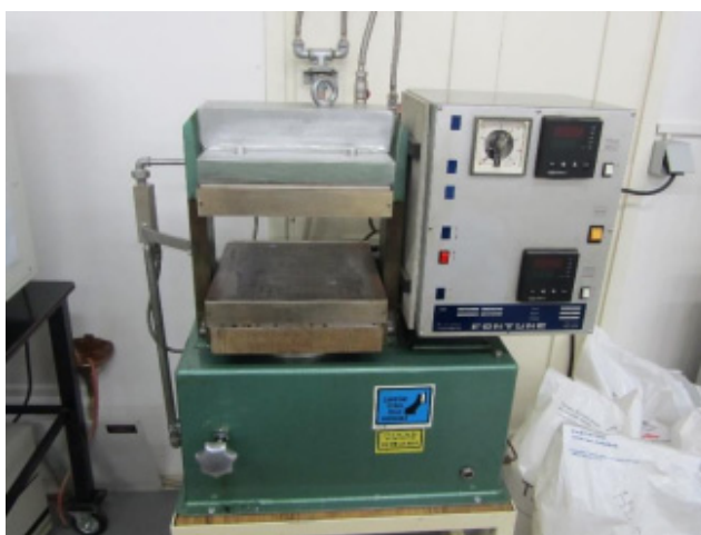
Slika 20. Hidraulička preša Fontune
