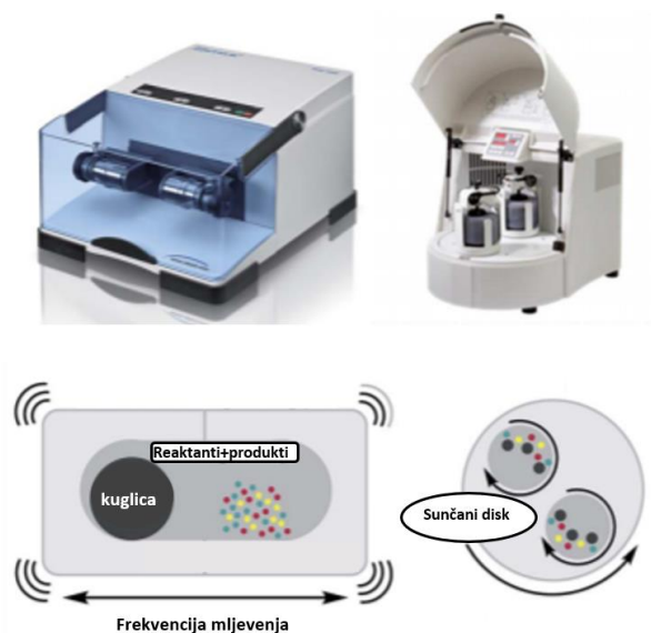
Slika 3. Razlika između vibracijskog i planetarnog mlina. 8,9
