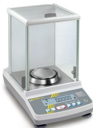
Slika 22. Fotografija analitičke vage KERN ALJ 220-4NM (KERN, Balingen, SR Njemačka)
