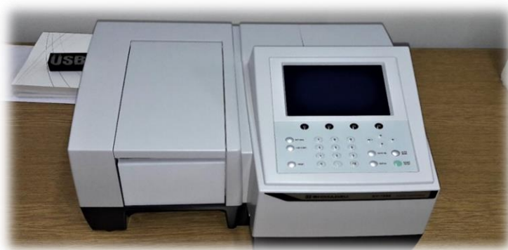
Slika 24. Fotografija spektrofotometra UV-1280 (Shimadzu, Kyoto, Japan)
