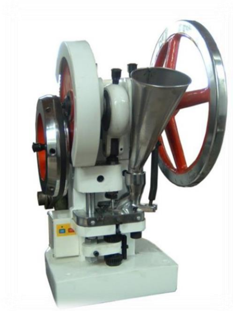
Slika 15. Fotografija uređaja za tabletiranje TDP-5T (Zhejiang Wisely Machinery Co., NR Kina)
