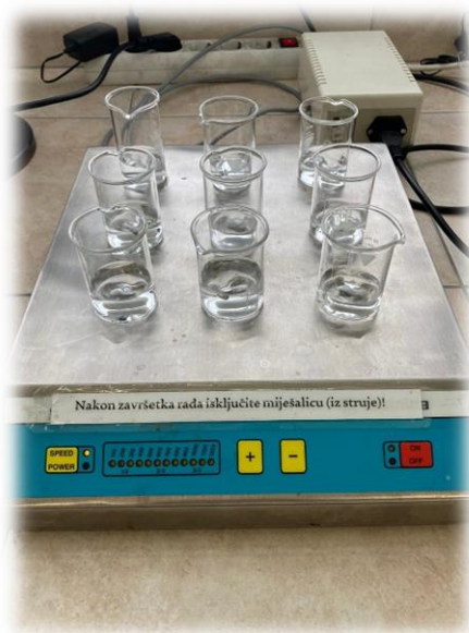
Slika 21. Fotografija Magnetska miješalica Tehnica Rotamix 609 MM
