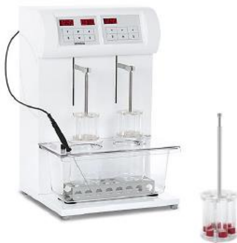
Slika 23. Fotografija uređaja za ispitivanje raspadljivosti tableta/minitableta ZT 322 (Erweka GmbH, Langen, SR Njemačka)
