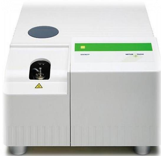
Slika 17. Fotografija diferencijalnog pretražnog kalorimetra Mettler Toledo 822 e (Mettler Toledo GmbH, Greifensee, Švicarska)
