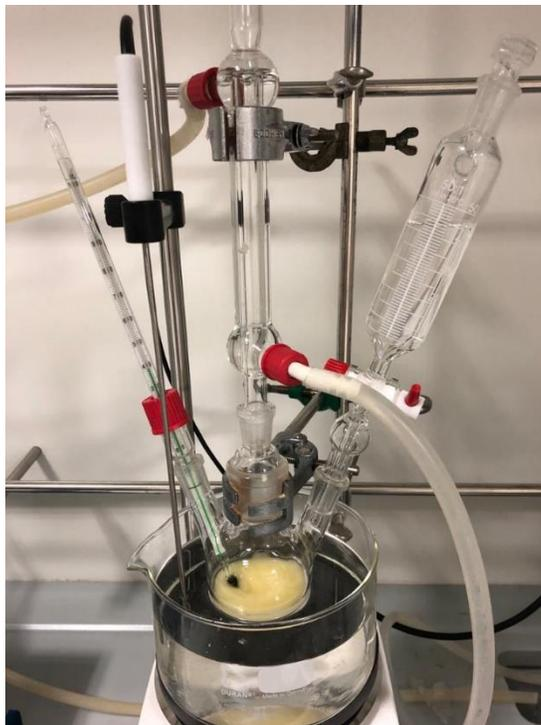
Slika 3.3. Aparatura za određivanje potencijalnih antiotapala
