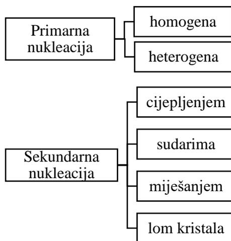
Slika 2.6. Mehanizmi nukleacije<sup>4</sup>
