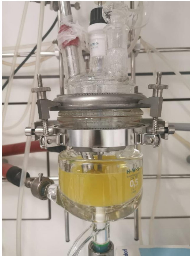
Slika 3.2. Reaktor s miješalom s aksijalnim tokom
