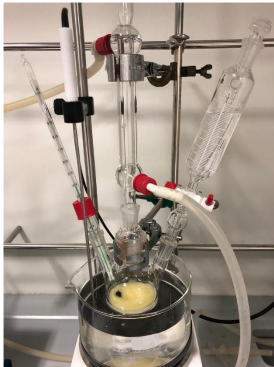
Slika 3.3. Aparatura za određivanje potencijalnih antiotapala
