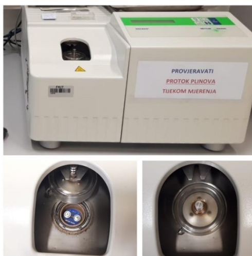
Slika 23. DSC uređaj, Mettler Toledo DSC 823e
