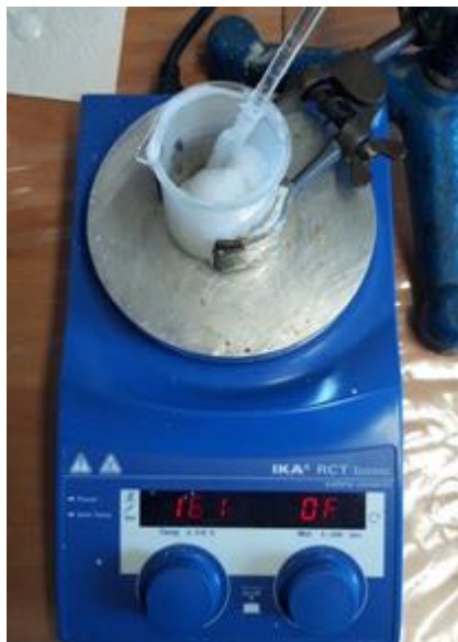
Slika 18. Priprema smjese na mješalici
