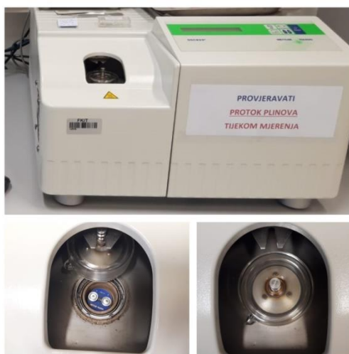
Slika 23. DSC uređaj, Mettler Toledo DSC 823e
