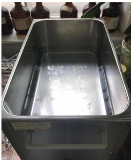
**Slika 3.3. Ultrazvučni uređaj**
