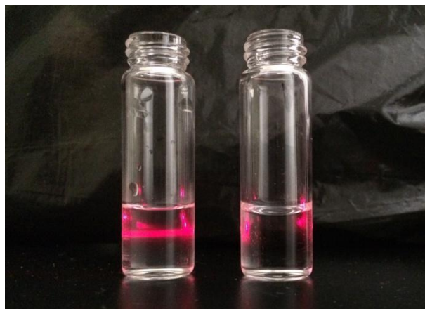
Slika 35. Proba na Tyndallov efekt polimernih nanočestica dopiranih bojilom 1 (voda s nanočesticama – lijevo; čista voda – desno)
