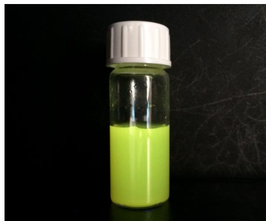
Slika 31. Stock otopina polimernih nanočestica dopiranih bojilom 1 na danjem svjetlu (a); Stock otopina polimernih nanočestica dopiranih bojilom 1 pod UV lampom (b) ( \gamma = 0,6 \text{ mg} / 5 \text{ mL} )
