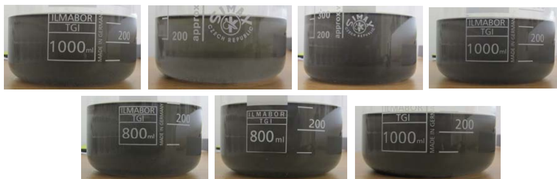
Slika 4.2.11. Fotografije uzoraka s grafitom neposredno nakon ultrazvučne homogenizacije ( s lijeva na desno: P8CC13, P8TWCC13, P8TXCC13, P8PACC13, P8PSCC13, P8DPACC13, P8DPSCC13)
