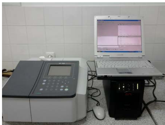
Slika 3.2.2. Spektrofotometar Shimadzu UV-1800
