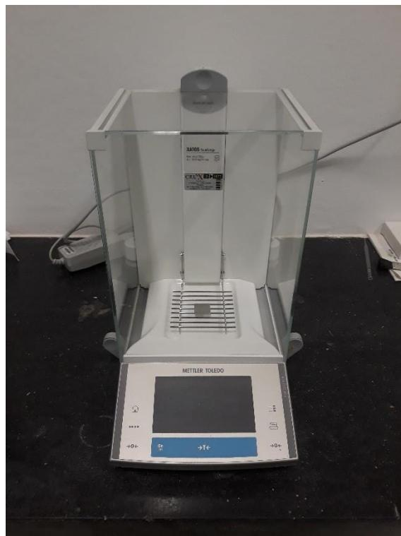
Slika 7. Analitička vaga Mettler Toledo XA105 DualRange
