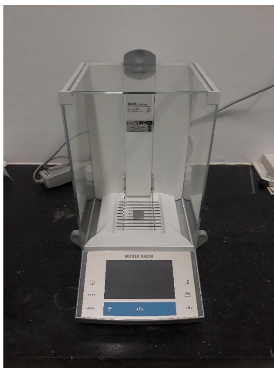
Slika 7. Analitička vaga Mettler Toledo XA105 DualRange
