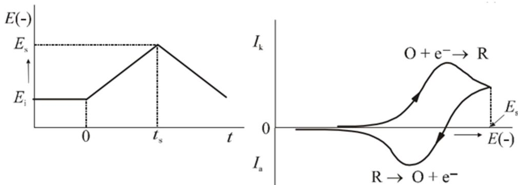
**Slika 18.** Krivulja pobude potencijal-vrijeme (lijevo) i odziva struja-potencijal (desno) u cikličkoj voltametriji [43].
