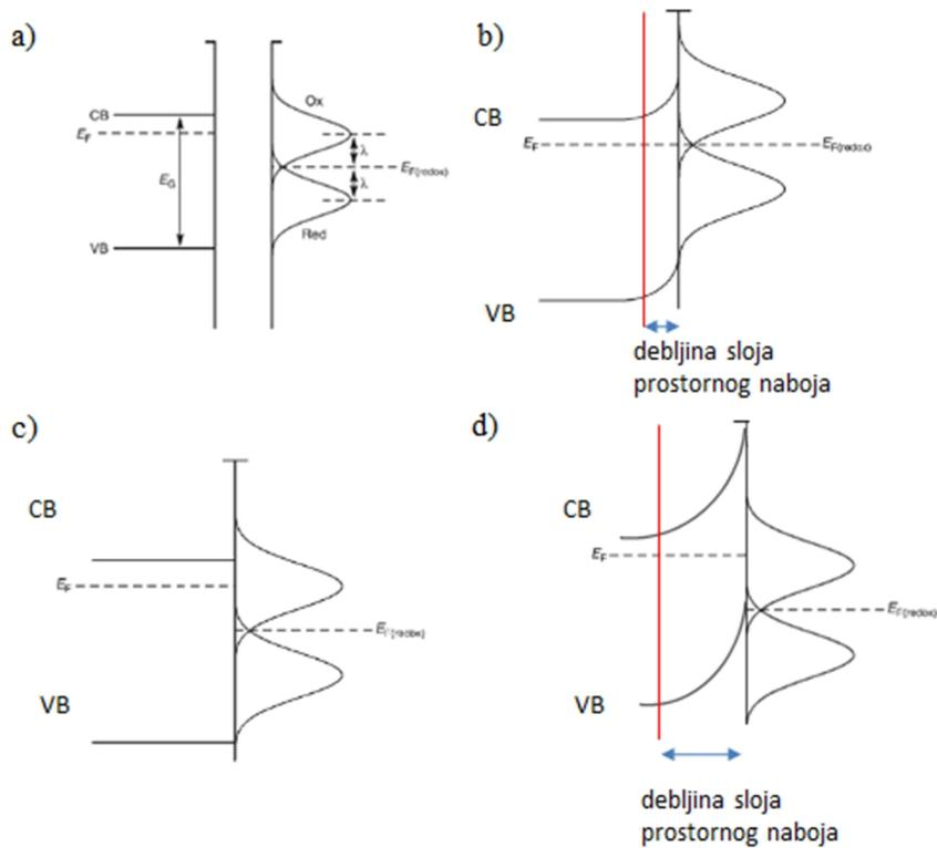
**Slika 52.** Shematski prikaz za n-tip poluvodiča koji uključuje valentnu i vodljivu vrpcu (VB, CB), Fermijev nivo ( $E_F$ ) i redoks stanje u otopini. Prikaz a) prije kontakta poluvodiča i otopine, b) nakon kontakta poluvodiča i otopine, c) uz osvjetljenje poluvodiča u otopini i d) uz anodnu polarizaciju osvijetljenog poluvodiča u otopini [66].
