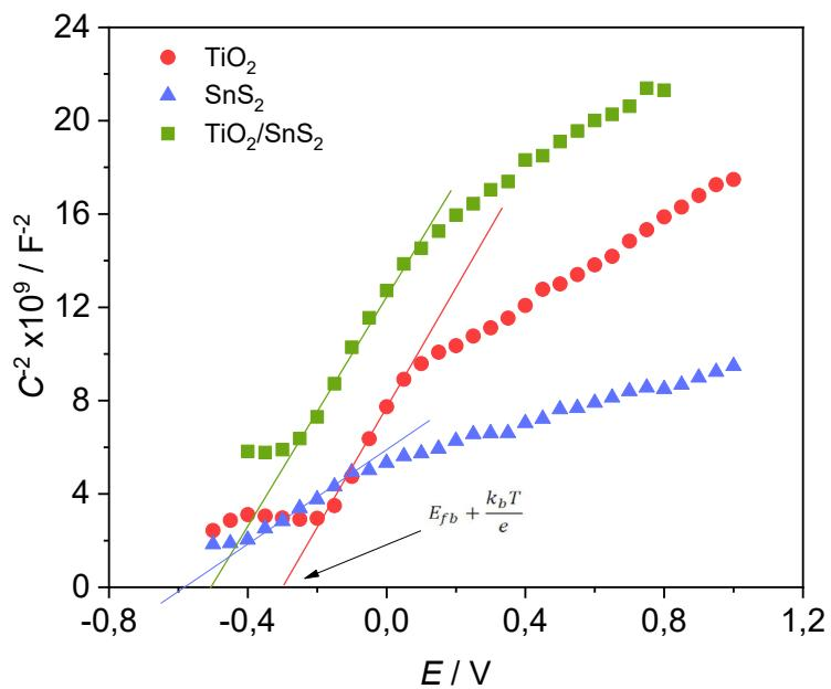
**Slika 47.** Mott-Schottky analiza triju korištenih elektroda,  $\text{TiO}_2$ ,  $\text{SnS}_2$  i kompozitne elektrode. Krivulje su snimljene pri frekvenciji od 1 kHz, u rasponu od  $-0,5$  do  $1,0$  V i uz upotrebu LED svjetla.
