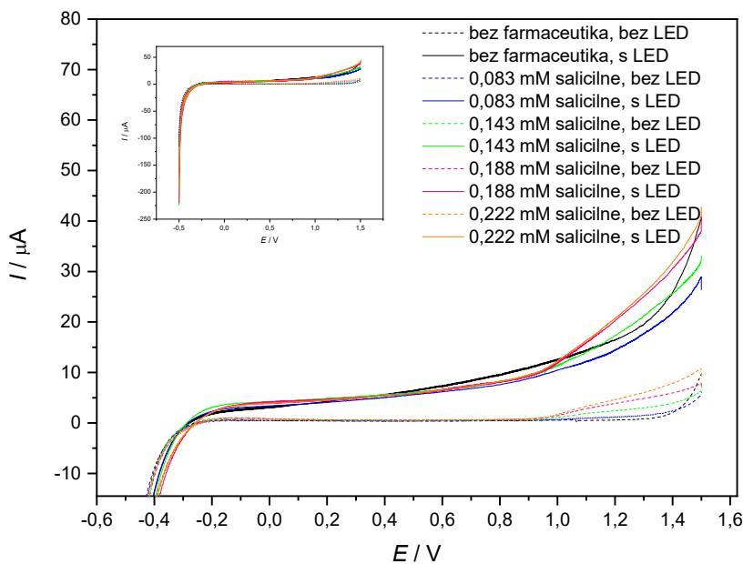
**Slika 34.** Voltamogrami zabilježeni za elektrodu oslojenu  $\text{SnS}_2$  u  $0,1 \text{ mol dm}^{-3}$  otopini natrijevog klorida te u otopinama salicilne kiseline različitih koncentracija bez primjene i s primjenom LED svjetla.
