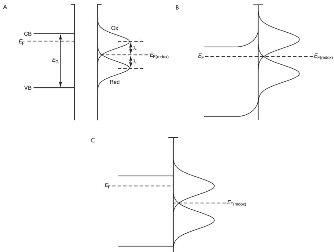
**Slika 23.** A) Shematski prikaz poluvodiča n-tipa i redoks stanja u otopini; gustoća redoks stanja predstavljena je odvojenim Gaussovim raspodjelama za pojedinu redoks vrstu, B) elektronske ravnoteže između poluvodiča n-tipa i redoks para u otopini i C) energetskih stanja pri *flat-band* potencijalu poluvodiča,  $E_{FB}$  [66].
