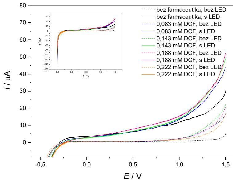
**Slika 33.** Voltamogrami zabilježeni za  $\text{SnS}_2$  u  $0,1 \text{ mol dm}^{-3}$  otopini natrijevog klorida te u otopinama diklofenaka različitih koncentracija bez primjene i s primjenom LED svjetla.
