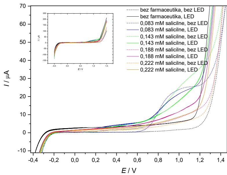
**Slika 37.** Rezultati polarizacije kompozitne elektrode. Mjerena su izvedena u  $0,1 \text{ mol dm}^{-3}$  otopini natrijevog klorida te u otopinama salicilne kiseline različitim koncentracijama bez primjene i s primjenom UV osvjetljenja.
