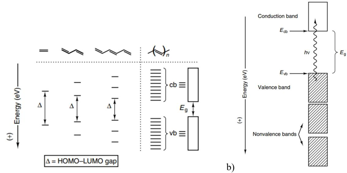
**Slika 8.** Prikaz a) nastajanja polienske vrpčaste strukture preklapanjem rastućeg broja MO etilena, i b) vrpčaste strukture poluvodiča; iscrtkana područja označavaju popunjene vrpce, a neiscrtkano praznu, vodljivu vrpcu [41].
