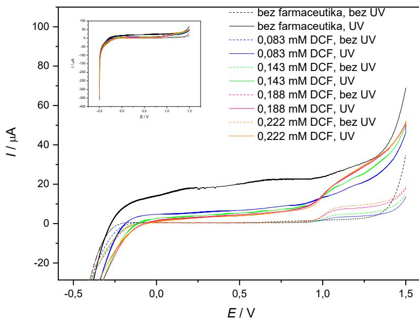
**Slika 29.** Prikaz mjerena linearom polarizacijom izvedenih na laboratorijski sintetiziranoj TiO<sub>2</sub> elektrodi. Mjerena su izvedena u 0,1 mol dm<sup>-3</sup> otopini natrijevog klorida te u otopinama diklofenaka različitih koncentracija bez primjene i s primjenom UV osvjetljenja.
