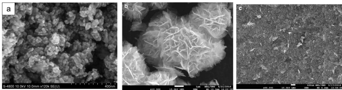
**Slika 51.** SEM mikrografije a) TiO<sub>2</sub> P25 [69], b) SnS<sub>2</sub> [70] i kompozita [70].
