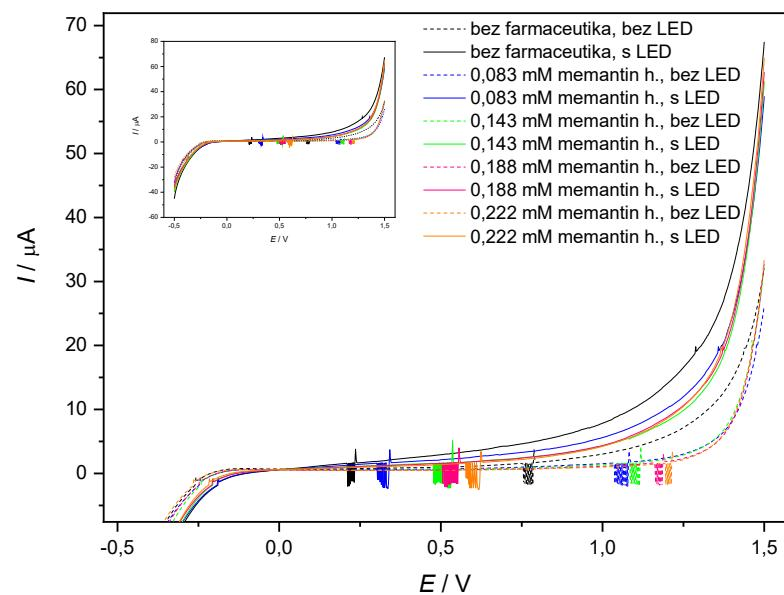
**Slika 38.** Prikaz strujnog odziva kao funkcije primijenjenog potencijala za elektrodu oslojenu kompozitom. Mjerena su izvedena u  $0,1 \text{ mol dm}^{-3}$  otopini natrijevog klorida te u otopinama memantin hidroklorida različitim koncentracijama bez primjene i s primjenom LED svjetla.
