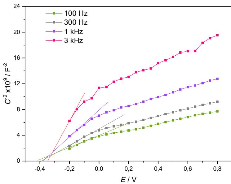
**Slika 46.** Mott-Schottky prikaz pri različitim frekvencijama. Krivulje su snimljene uz  $\text{TiO}_2$  katalizator u otopini  $\text{NaCl}$ , raspon potencijala  $-0,2 - 0,8$  V i amplitudu pobude potencijala 5 mV.
