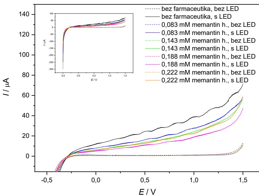
**Slika 35.** Voltamogrami dobiveni za elektrodu oslojenu  $\text{SnS}_2$  u  $0,1 \text{ mol dm}^{-3}$  otopini natrijevog klorida te u otopinama memantin hidroklorida različitih koncentracija bez primjene i s primjenom LED osvjetljenja.
