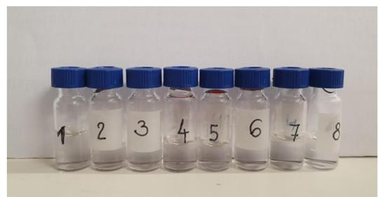
**Slika 28.** Uzorci otopine DCF za HPLC analizu.
