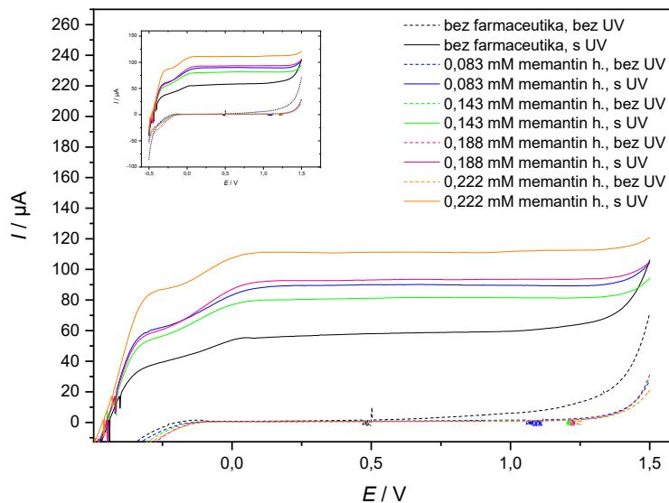
**Slika 32.** Voltamogrami zabilježeni polarizacijom elektrode oslojene komercijalnim  $\text{TiO}_2$ . Mjerena su izvedena u  $0,1 \text{ mol dm}^{-3}$  otopini natrijevog klorida te u otopinama memantin hidroklorida različitih koncentracija bez primjene i s primjenom UV osvjetljenja.
