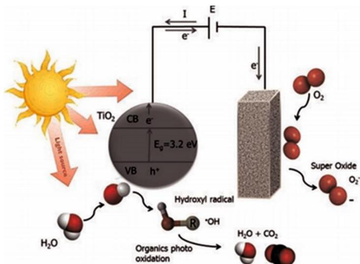
**Slika 17.** Mehanizam razdvajanja naboja u fotoelektrokemijskom sustavu [49].
