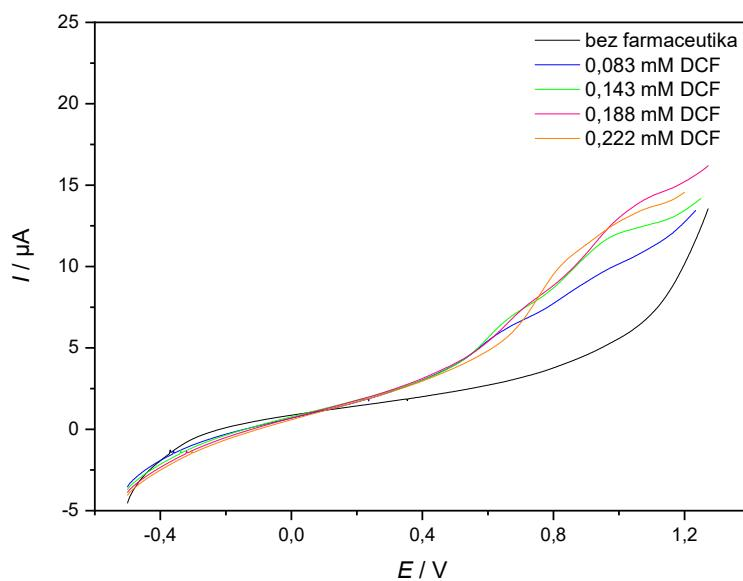
**Slika 39.** Voltamogrami dobiveni mjerjenjima s grafitnom disk elektrodom. Mjerena su izvedena u  $0,1 \text{ mol dm}^{-3}$  otopini natrijevog klorida te u otopinama diklofenaka različitih koncentracija.
