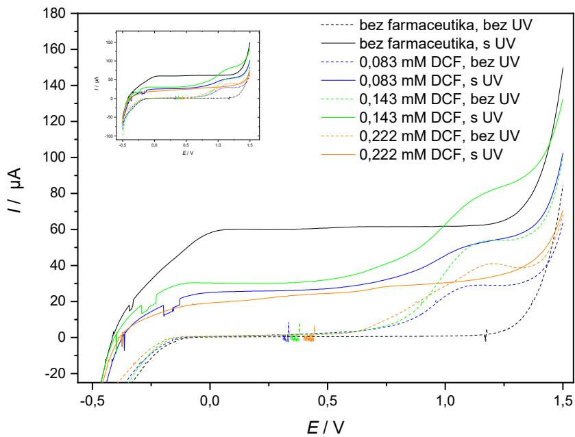
**Slika 30.** Voltamogrami zabilježeni za elektrodu oslojenu komercijalnim TiO<sub>2</sub>. Mjerenja su izvedena u  $0,1 \text{ mol dm}^{-3}$  otopini natrijevog klorida te u otopinama diklofenaka različitih koncentracija bez primjene i s primjenom UV osvjetljenja.
