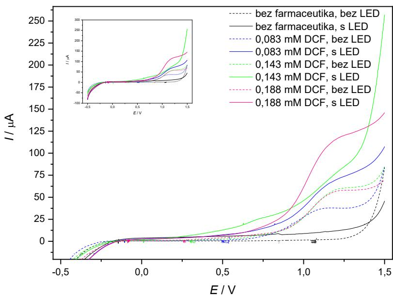
**Slika 36.** Prikaz strujnog odziva kao funkcije primijenjenog potencijala za elektrodu oslojenu kompozitnim slojem. Mjerena su izvedena u  $0,1 \text{ mol dm}^{-3}$  otopini natrijevog klorida te u otopinama DCF-a različitih koncentracija bez primjene i s primjenom LED osvjetljenja.
