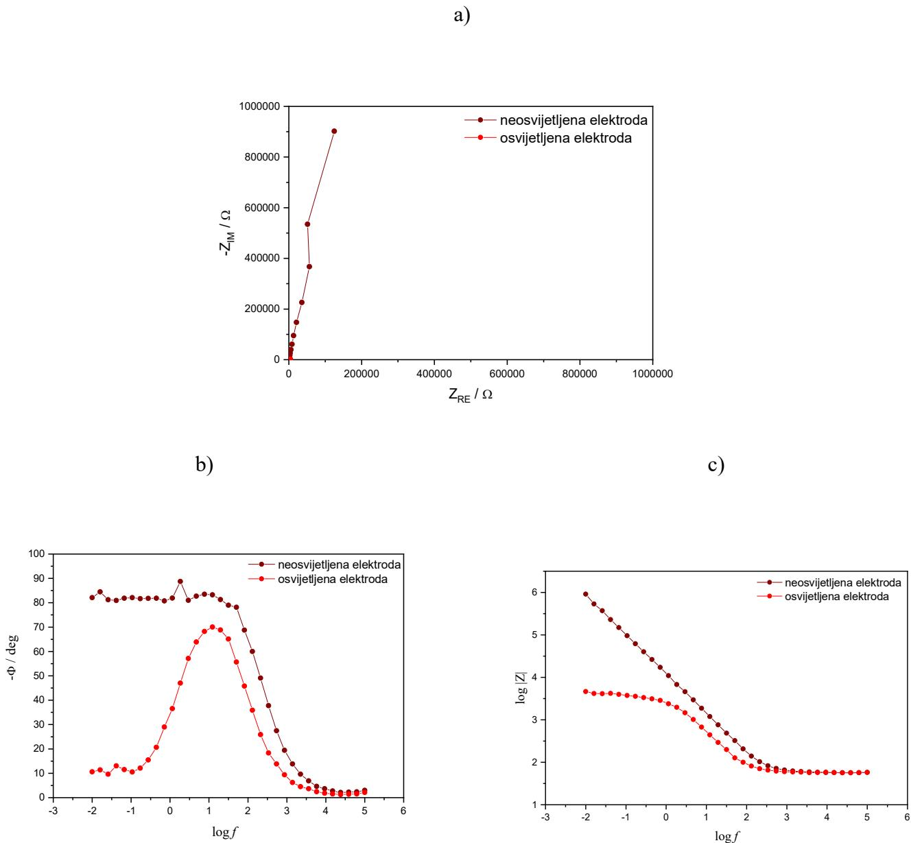
**Slika 43.** Prikaz impedancijskih odziva  $\text{TiO}_2$  elektrode ispitane u otopini natrijeva klorida: a) Nyquistov dijagram, b) Bodeov dijagram ovisnosti faznog kuta o  $\log f$ , c) Bodeov dijagram ovisnosti  $\log|Z|$  o  $\log f$ .
