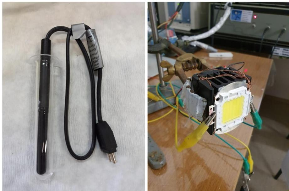
**Slika 25.** UV i LED lampa korištene tijekom fotoelektrokemijskih mjerena.
