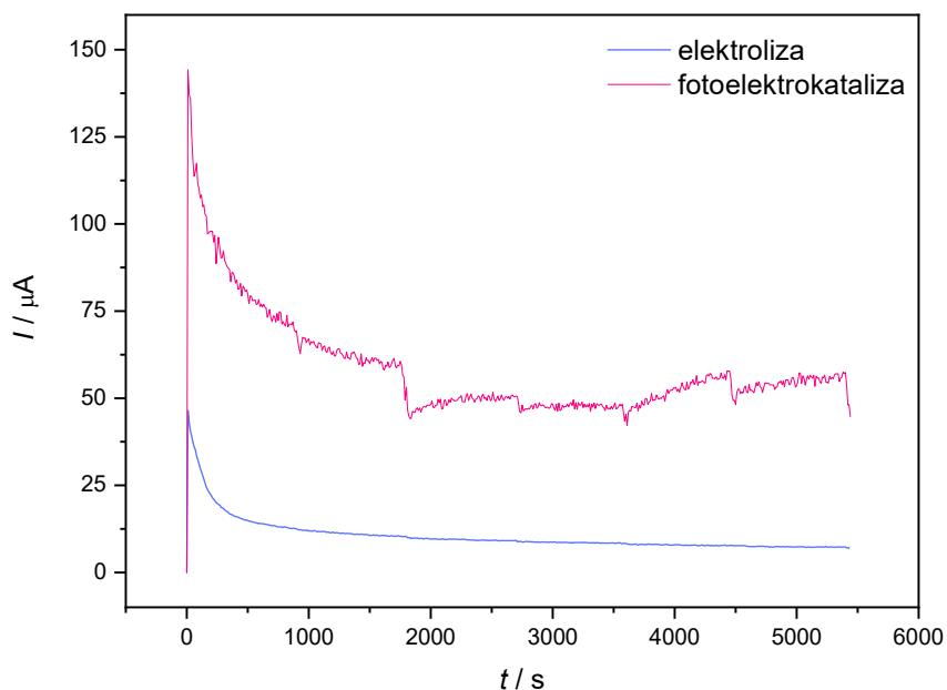
**Slika 42.** Usporedba strujnog odziva elektrolitičkog i fotoelektrokatalitičkog procesa u  $0,1 \text{ mmol dm}^{-3}$  otopini DCF pri naponu od 1,2 V.
