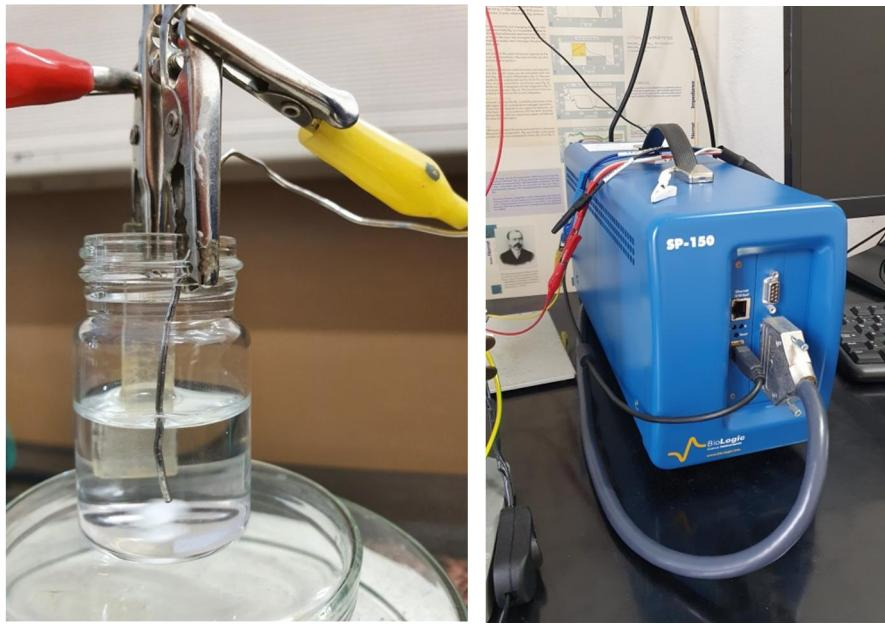
**Slika 27.** Dvoelektrodnji sustav za provedbu fotoelektrokatalize (lijevo), potencijostat (desno).
