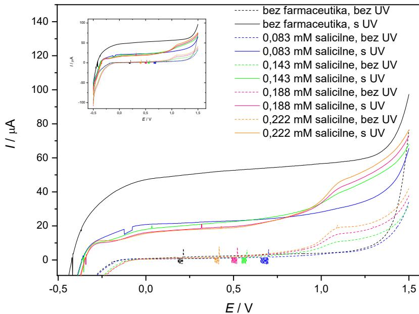
**Slika 31.** Strujni odzivi za elektrodu oslojenu komercijalnim  $\text{TiO}_2$ . Mjerena su izvedena u  $0,1 \text{ mol dm}^{-3}$  otopini natrijevog klorida te u otopinama salicilne kiseline različitih koncentracija bez primjene i s primjenom UV osvjetljenja.
