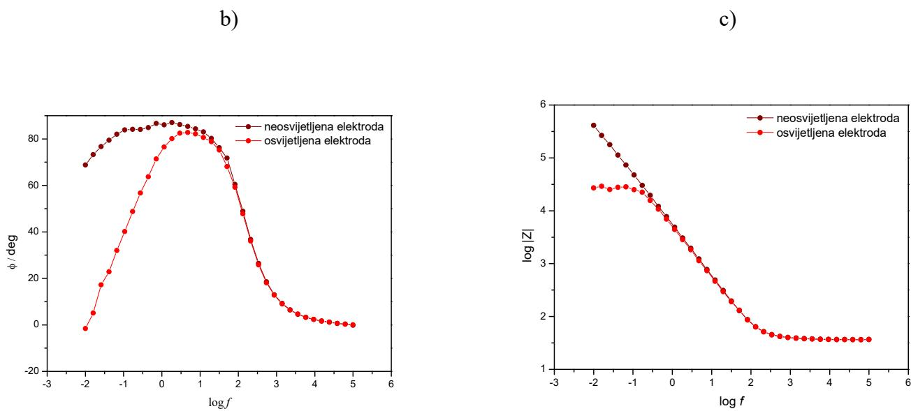
**Slika 45.** Prikaz impedancijskih odziva  $\text{TiO}_2/\text{SnS}_2$  elektrode ispitane u otopini natrijeva klorida: a) Nyquistov dijagram, b) Bodeov dijagram ovisnosti faznog kuta o  $\log f$ , c) Bodeov dijagram ovisnosti  $\log|Z|$  o  $\log f$ .
