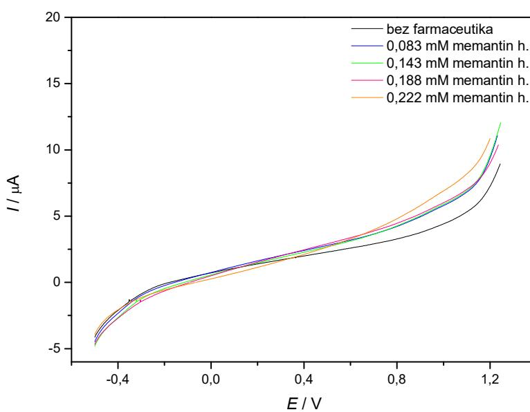
**Slika 41.** Voltamogrami zabilježeni pri mjeranjima s grafitnom disk elektrodom. Mjerena su izvedena u  $0,1 \text{ mol dm}^{-3}$  otopini natrijevog klorida te u otopinama memantin hidroklorida različitih koncentracija.
