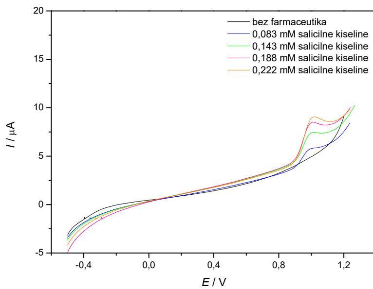
**Slika 40.** Voltamogrami zabilježeni pri mjeranjima s grafitnom disk elektrodom. Mjerena su izvedena u  $0,1 \text{ mol dm}^{-3}$  otopini natrijevog klorida te u otopinama salicilne kiseline različitih koncentracija.
