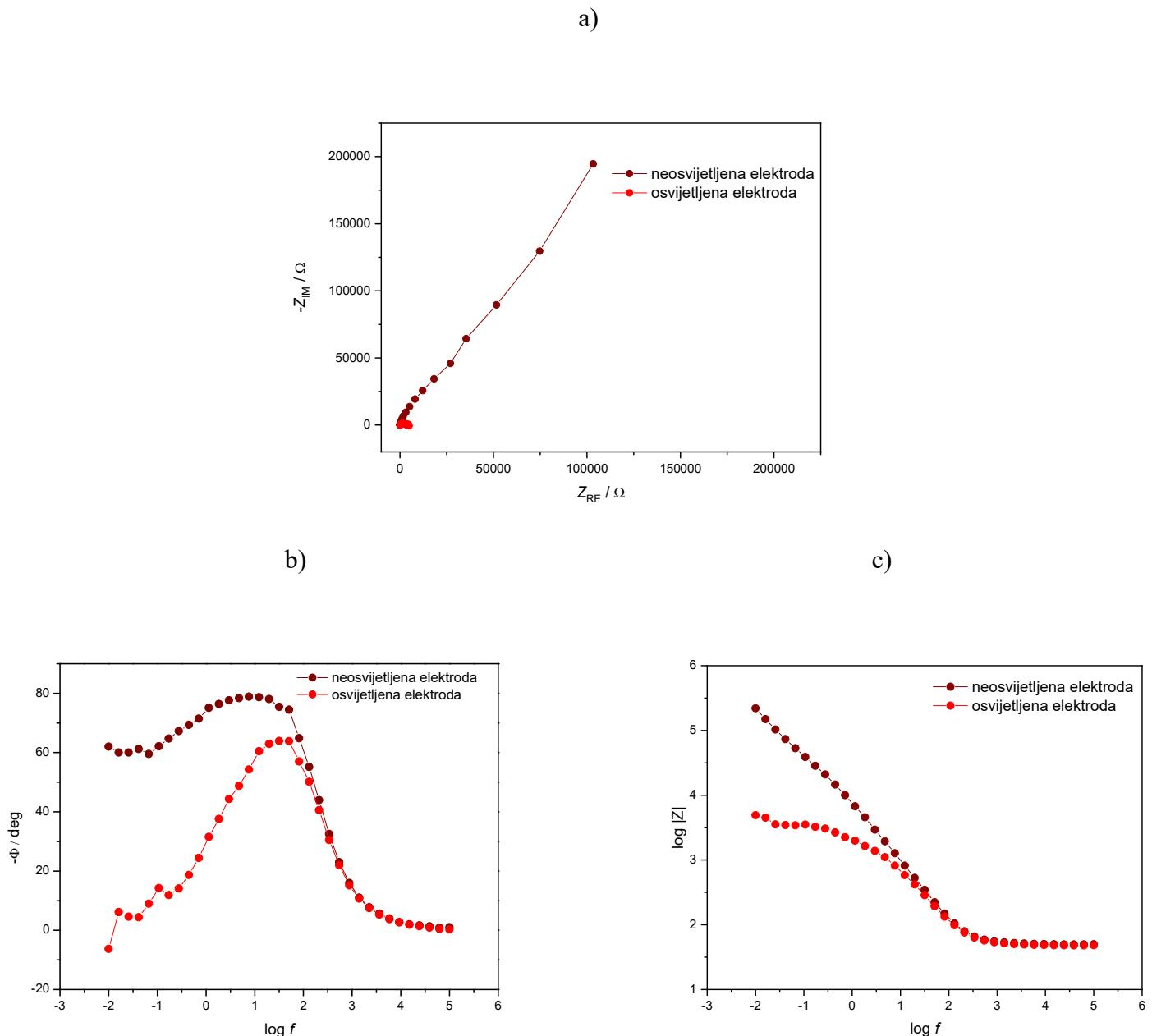
**Slika 44.** Prikaz impedancijskih odziva  $\text{SnS}_2$  elektrode ispitane u otopini natrijeva klorida: a) Nyquistov dijagram, b) Bodeov dijagram ovisnosti faznog kuta o  $\log f$ , c) Bodeov dijagram ovisnosti  $\log|Z|$  o  $\log f$ .
