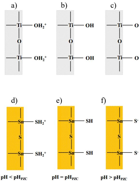
**Slika 53.** Shematski prikaz naboja površine  $\text{TiO}_2$  i  $\text{SnS}_2$  u ovisnosti o pH vrijednosti
