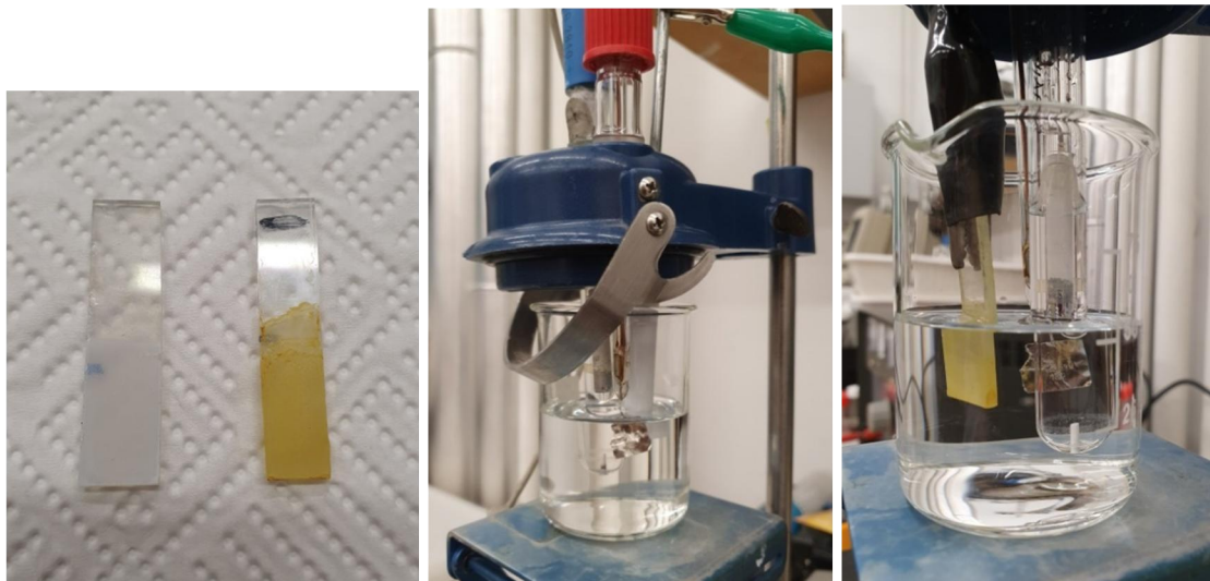
Slika 24. Radne elektrode (lijevo), troelektrodni sustav s disk elektrodom (sredina) i kompozitnom elektrodom kao radnom (desno).
