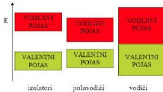
Slika 2.4. Shematski prikaz valentne i vodljive vrpce te zabranjene energetske zone za metal, poluvodič i izolator.
