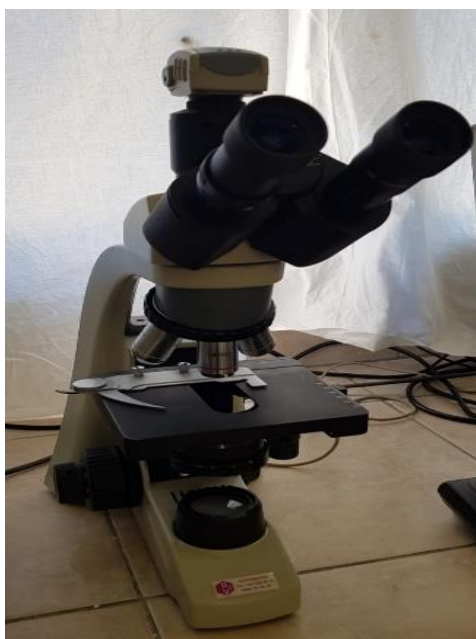
Slika 12.b Mikroskop Motic BA200 za određivanje stabilnosti NS-a
