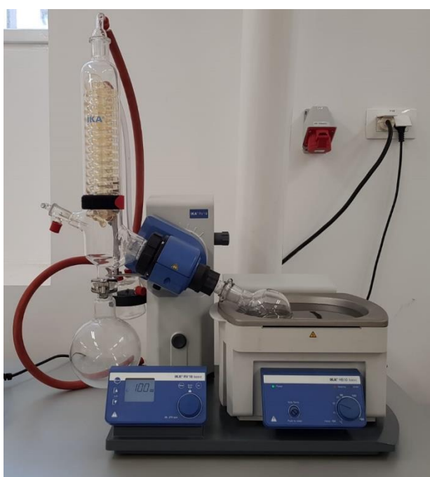
Slika 10. Rotacijski vakum isparivač IKA RV 10 Basic korišten za pripremu TBAB:MK (1:1)
