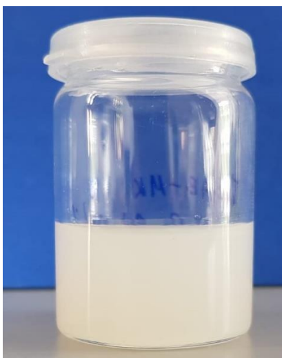
Slika 17.b Vizualna metoda određivanja stabilnost NS-a (7.dan)
