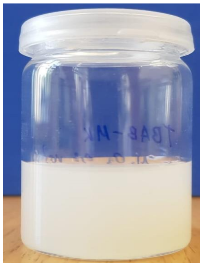
Slika 17.c Vizualna metoda određivanja stabilnost NS-a (14.dan)
