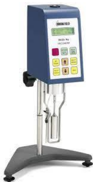
Slika 13.b Termostatiranom reometru DV-III ULTRA, Brookfield za određivanje viskoznosti NS-a i DES-a
