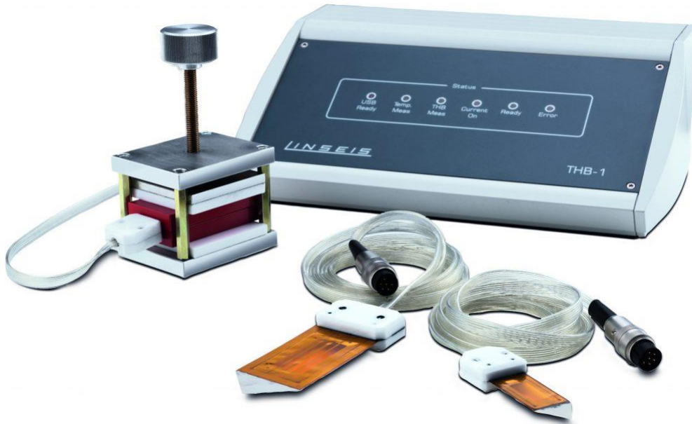
Slika 14. Transient Hot Bridge (THB) Thermal Conductivity Meter za mjerenje toplinskih svojstava DES-a
