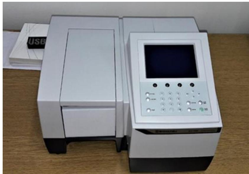
**Slika 4.7.** Fotografija spektrofotometra UV-1280 (Shimadzu, Kyoto, Japan)
