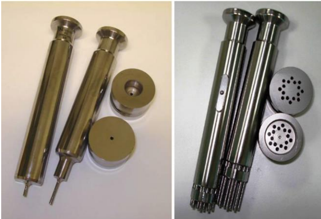
Slika 3.4. Alati za tabletiranje s a) jednim vrhom i b) više vrhova.
