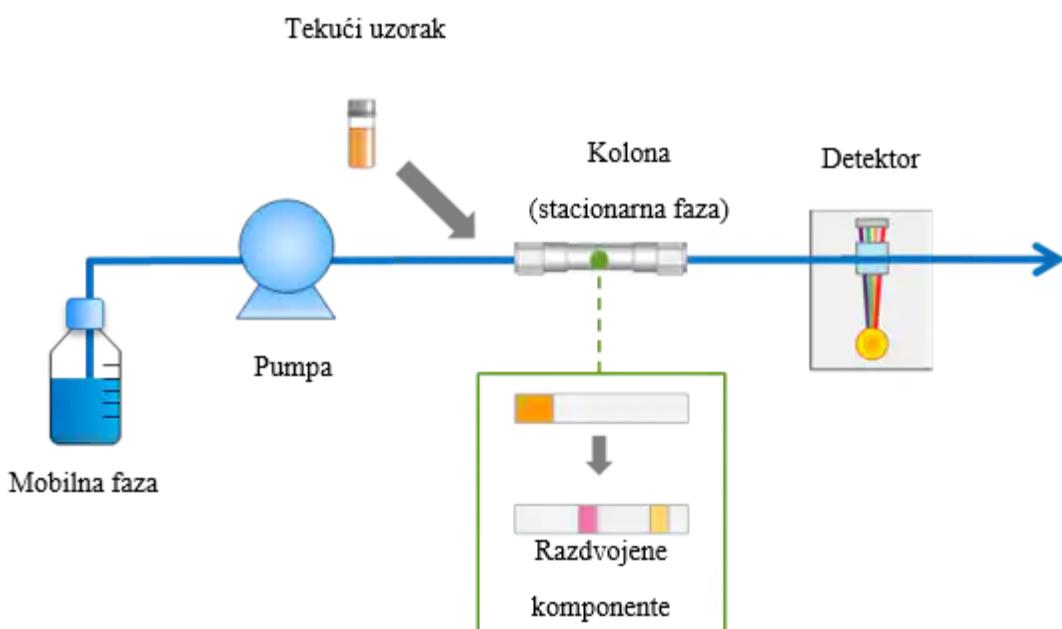
**Slika 3.7.** Shematski prikaz kapljivinske kromatografije visoke djelotvornosti.<sup>15</sup>
